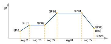
Ferramenta disponivel no software Dalí, que possibilita a criação de processos térmicos, onde a temperatura (SP), de acordo com os tempos programados é automaticamente alterada pelo sistema, sem a necessidade da intervenção do operador.
