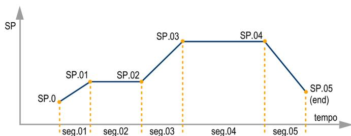
Ferramenta disponível no software Dalí, que possibilita a criação de processos térmicos, onde a temperatura (SP), de acordo com os tempos programados é automaticamente alterada pelo sistema, sem a necessidade da intervenção do operador. Ao final é possível emitir os relatórios dos métodos de rampa/patamar criados.
